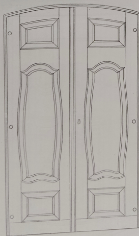
Fig. 5.—Puerta para la salida al coro 2 m. 0.32 X 1 m. 0.32
