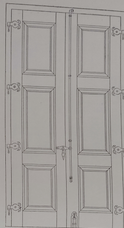
Fig. 8.—Puerta de la Capilla del Santísimo (lado interior) 2 m. 0.80 \times 1 m. 0.43
